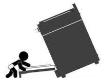
Le support anti-basculement livré avec la cuisinière **doit être correctement fixé au mur postérieur ou au sol**, comme indiqué sur les images. Faire glisser la cuisinière contre le mur jusqu'à ce que les supports soient complètement insérés dans leurs logements à l'arrière de la cuisinière.
